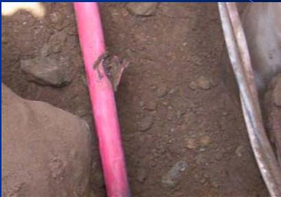
Pérdida de aislamiento de cables causados por envejecimiento o daño físico
